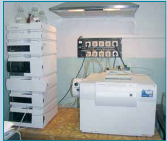
● Высокоэффективный жидкостный хроматограф Agilent 1200, с детектором типа ионная ловушка ESI-MS Agilent 6330
