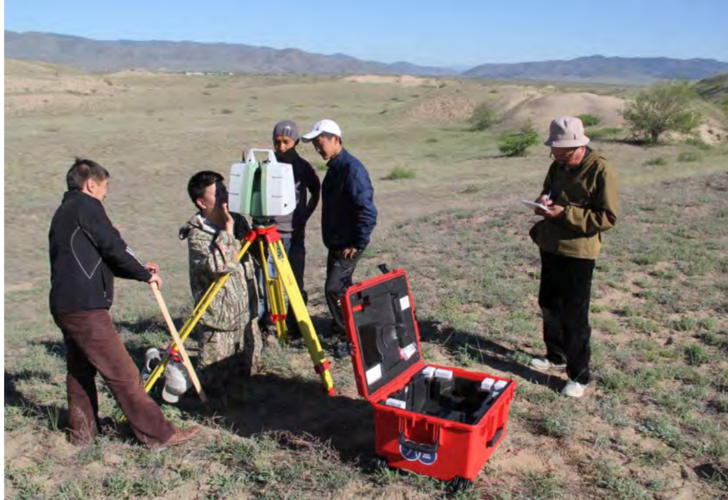
▲ РАБОТА С 3D НАЗЕМНОЙ ЛАЗЕРНОЙ СИСТЕМОЙ LEICA В ПЕСЧАНЫХ МАССИВАХ ДЭБЭНА
